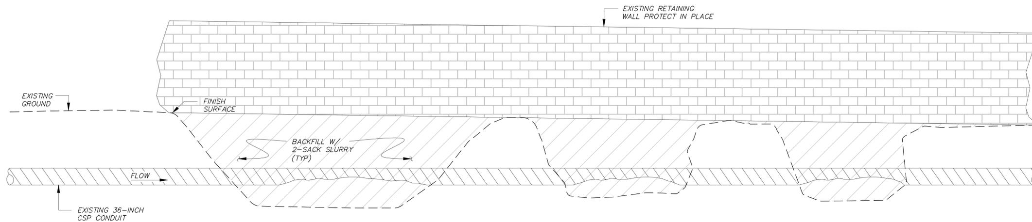
**SLURRY BACKFILL DETAIL PHASE I** (A)
